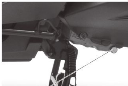
Vite di drenaggio (2)
