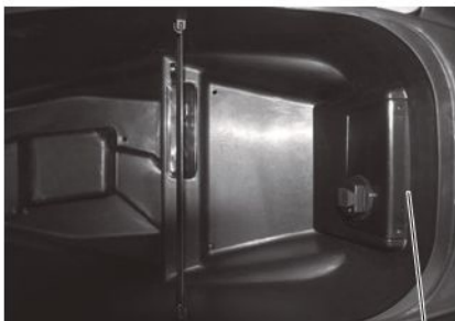
Connettore sistema di diagnosi (dietro coperchio)
