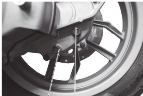
Vite di drenaggio (1)
