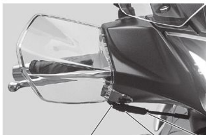
Vite di regolazione (2)
